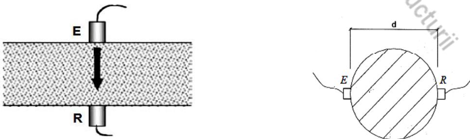
**Figura 2 - Tehnica transmisiei directe ultrasunetelor când emițătorul și receptorul sunt situați coaxial pe două fețe opuse ale elementului din beton**
