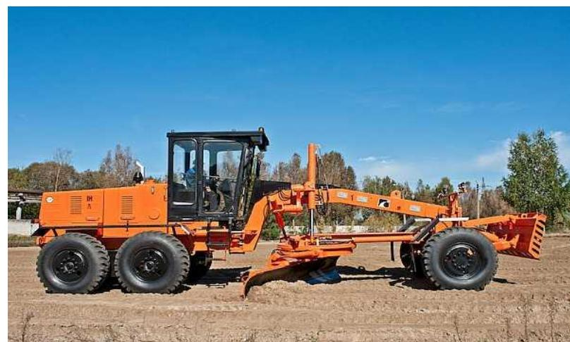
**Рисунок F.4** Планировка профиля дороги
