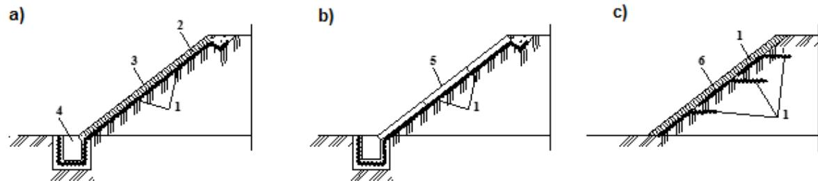
**Рисунок 10.2** Укрепление откосов земляного полотна ГМ в комбинации с решетчатыми конструкциями (а), бетонными плитами (б) и укрепление армированием поверхностной зоны (с)
