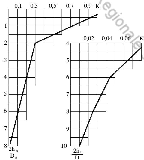
Рисунок 7.8 Зависимость коэффициента распределения напряжений  $K$  от относительной глубины  $\frac{2 \cdot h_h}{D_0}$
