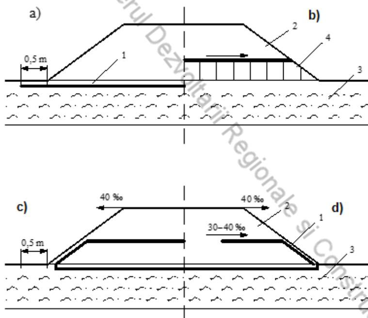
**Рисунок 7.1** Основные конструктивные решения при применении защитных (а, б) и защитно-армирующих (с, д) прослоек из ГМ при строительстве насыпей на слабом основании
