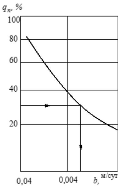
Рисунок 8.8 График для определения коэффициента  $b$ ;  $q_n$  – содержание песчаных частиц по весу
