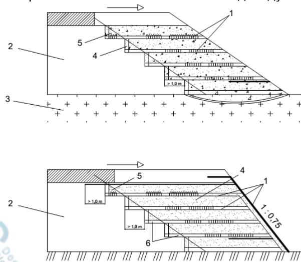
**Рисунок 7.4** Применение ГМ при уширении насыпей
