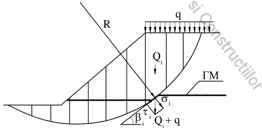
Рисунок 7.6 Схема к расчету насыпи на слабом основании с учетом прослойки из ГМ
