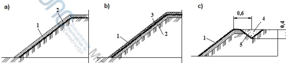
**Рисунок 10.1** Укрепление откосов земляного полотна биологическими типами укрепления с применением геосинтетических материалов
