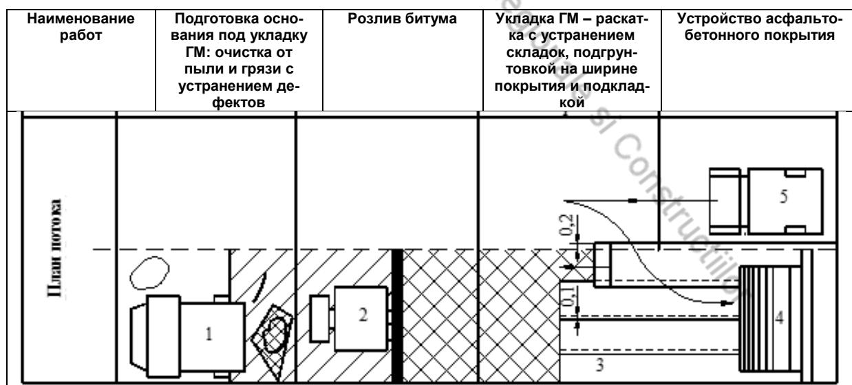
**Рисунок 8.11 Технологическая схема по устройству трещинопрерывающих прослоек из геосинтетических материалов в слоях асфальтобетонного покрытия**
