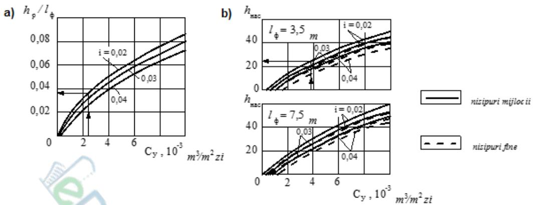
Figura 8.6 - Nomograma pentru calculul stratului drenant (determinarea  $h_{Hac}$  și  $C$ )
