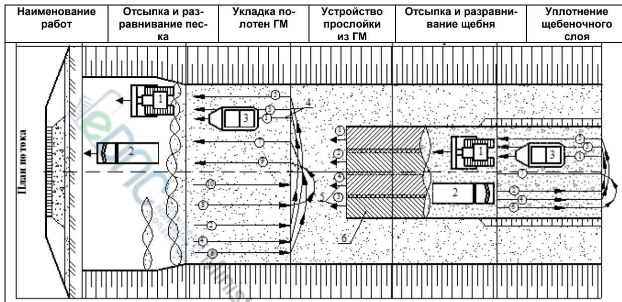
**Рисунок 8.10 Технологическая схема по устройству защитно-армирующих прослоек из ГМ под основанием дорожной одежды**
