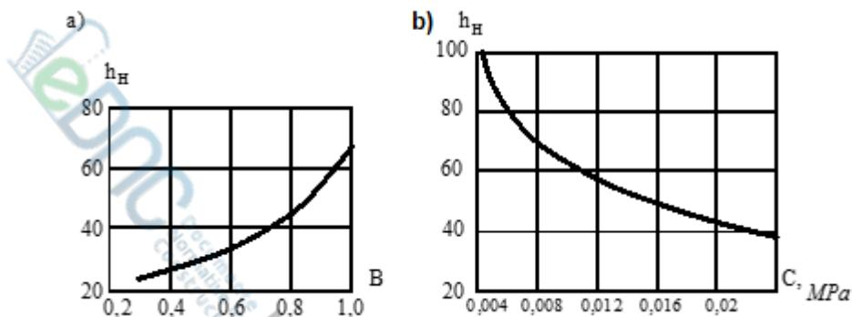
**Figura 7.10** - Graficele pentru determinarea  $h_H$  pentru utilizarea geotextilului conform parametrilor de calcul a sarcinii  $D_0=35$  cm și  $P=0,6$  MPa: a – în funcție de coeficientul de consistență  $B$ ; b – în funcție de rezistența la forfecare  $C$
