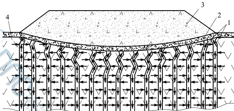
**Рисунок 7.3** Вертикальные ленточные дрены из ГМ для ускорения консолидации грунтов слабого основания
