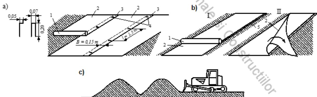
**Figura 7.12 - Metode de așternere a MG (a, b) și descărcarea pe suprafață MG a materialului (c)**
