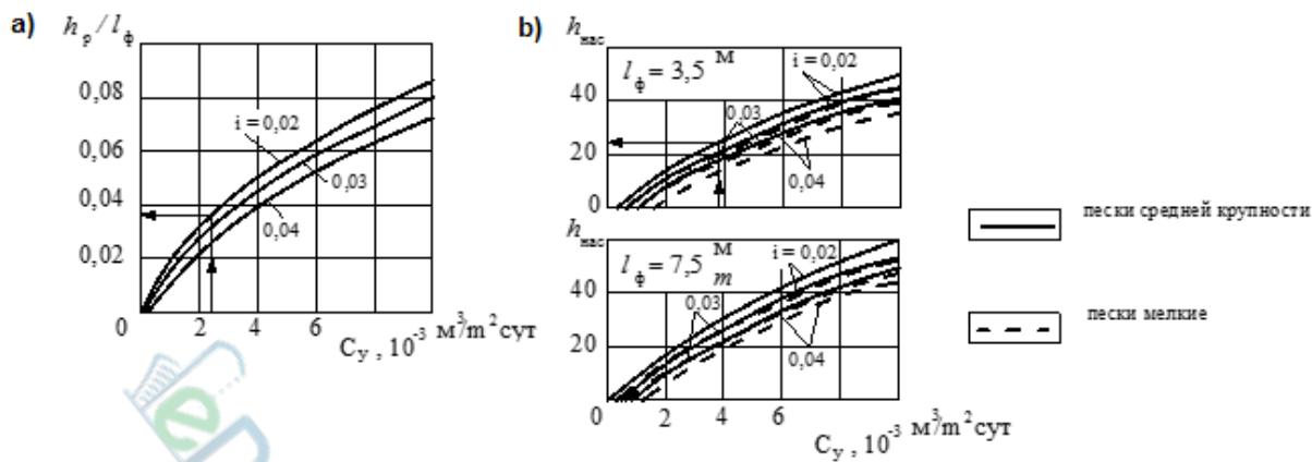
Рисунок 8.6 Номограмма к расчету дренирующего слоя (определение  $h_{nac}$  и  $C$ )
