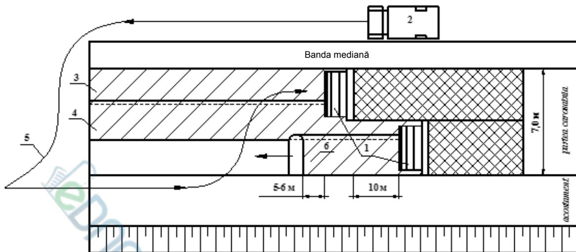
**Figura 8.12 - Schema de executare a lucrărilor de aşternere a MG în cazul executării îmbrăcăminte rutiere simultan pe o lățime de peste 6 m**
