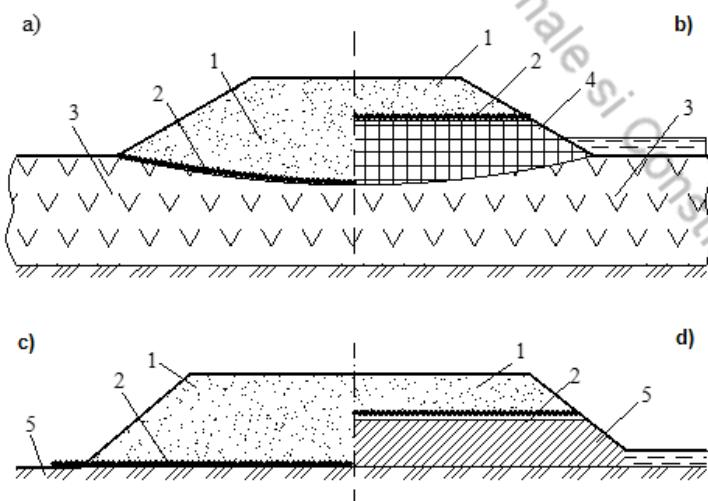
**Figura 7.2 - Scheme de construcții a drumurilor provizorii pe pămînturi slabe cu substrat din MG**
