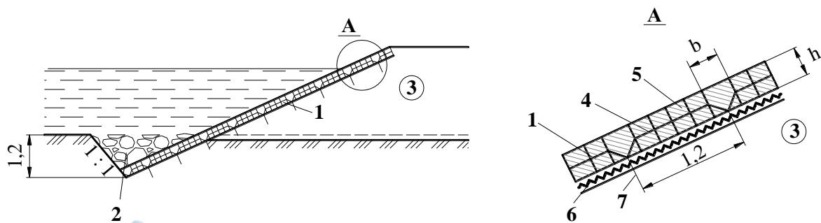
**Рисунок 10.3 Укрепление откосов земляного полотна с применением пространственных георешеток**
