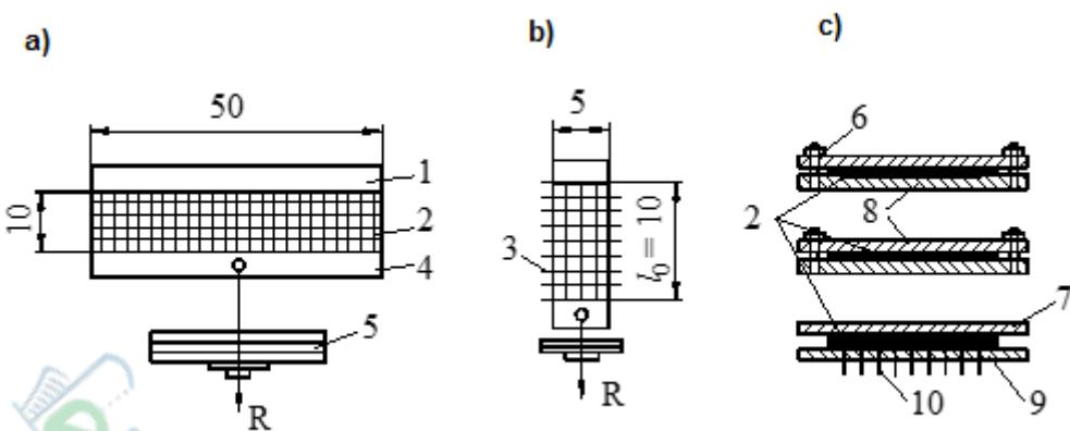
**Рисунок А.3 Схемы испытаний по методу длительного растяжения**
