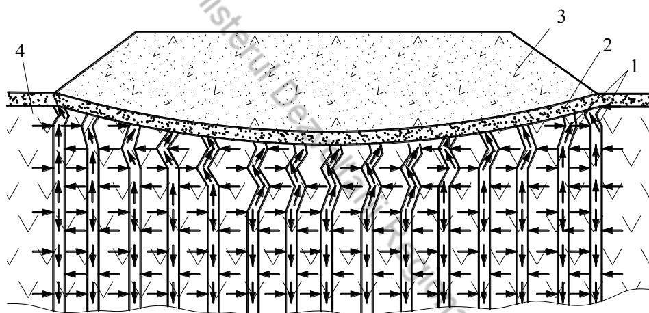
**Figura 7.3 - Drenuri cordelate verticale din MG pentru accelerarea consolidării pămînturilor din fundațiile slabe**
