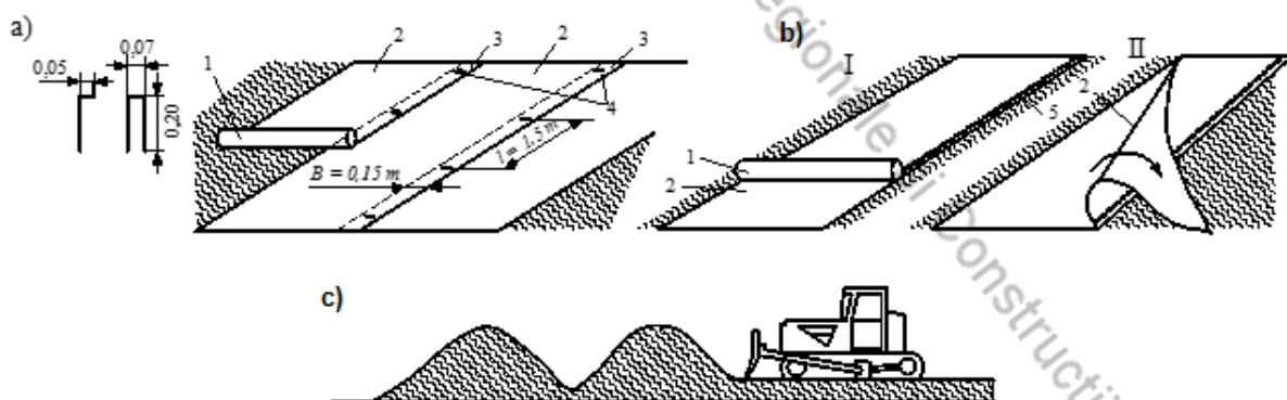
**Рисунок 7.12** Способы укладки ГМ (а, б) и отсыпка на поверхность ГМ материала (с) 1 и 2 – рулон и полотно ГМ; 3 – перекрытие полотен; 4 – анкера; 5 – соединение (сшивание) полотен по краю
