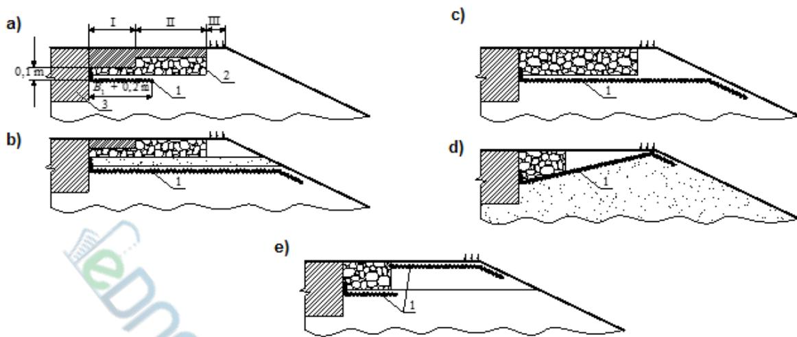
Рисунок 8.4 Основные конструкции укрепления обочин
