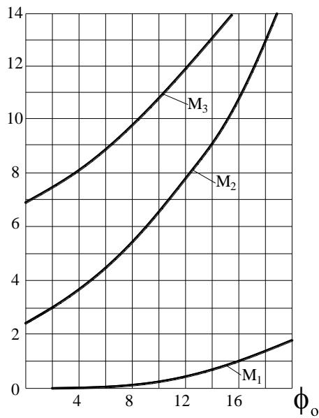
**Figura 7.9 - Relația între coeficienții  $M_1$ ,  $M_2$ ,  $M_3$  și unghiul de frecare interioară pământului din fundația slabă**
