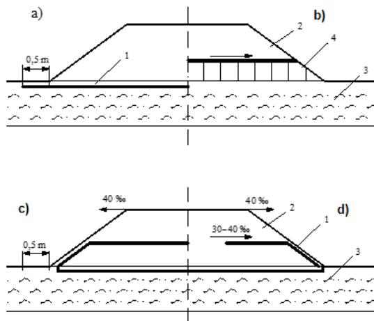
**Figura 7.1 - Soluții constructive de bază pentru utilizarea substraturilor din MG de protecție (a, b) și de protecție și armare (c, d) la construcția terasamentelor pe fundații slabe**
