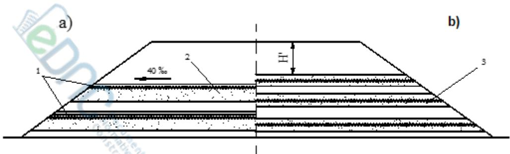
**Figura 7.5 - Utilizarea MG la executarea terasamentului din pămînturi cu umiditate sporită**
