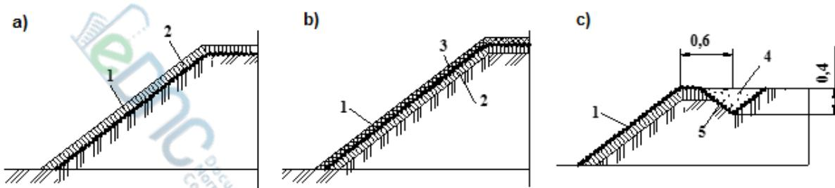
**Figura 10.1 - Consolidarea taluzurilor terasamentului cu tipuri biologice de consolidare, utilizând materiale geosintetice**
