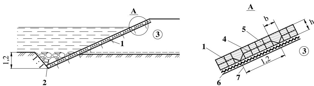
**Figura 10.3 - Consolidarea taluzurilor terasamentului cu utilizarea geocelulelor**
