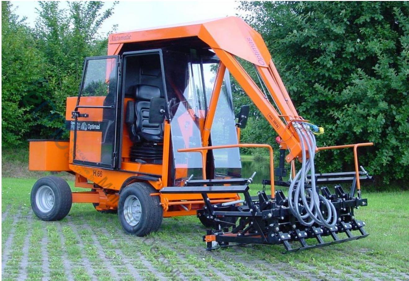
Рис. 5.1 Плитоукладчик
