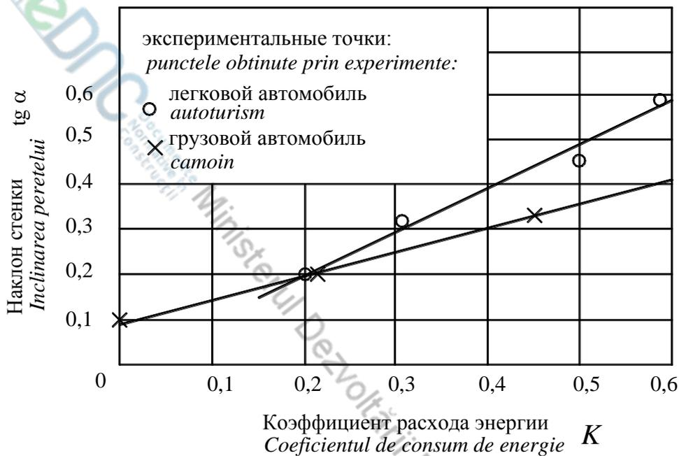
Рис. 3 Графики к определению высоты подъема колеса автомобиля, а следовательно, и энергоемкости parapетов с наклонной стенкой
